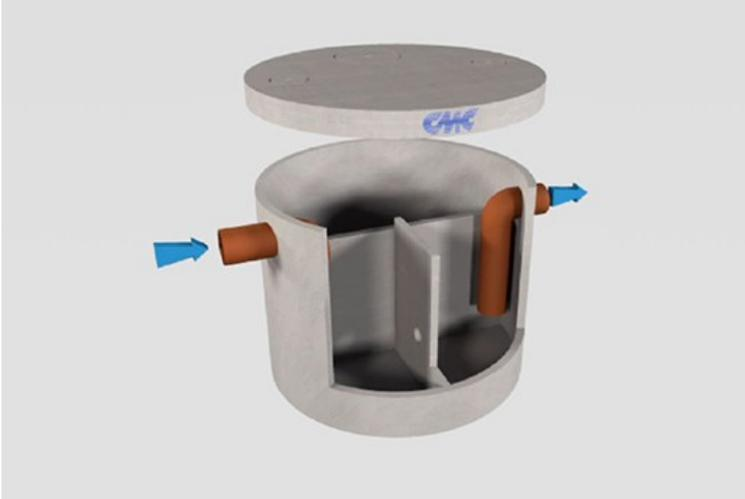
Disoleatori/dissabbiatori prefabbricati ideati per la separazione di liquidi leggeri per gravità e alla raccolta di sabbie e di altri materiali pesanti, realizzati in calcestruzzo armato vibrato con finitura industriale.
