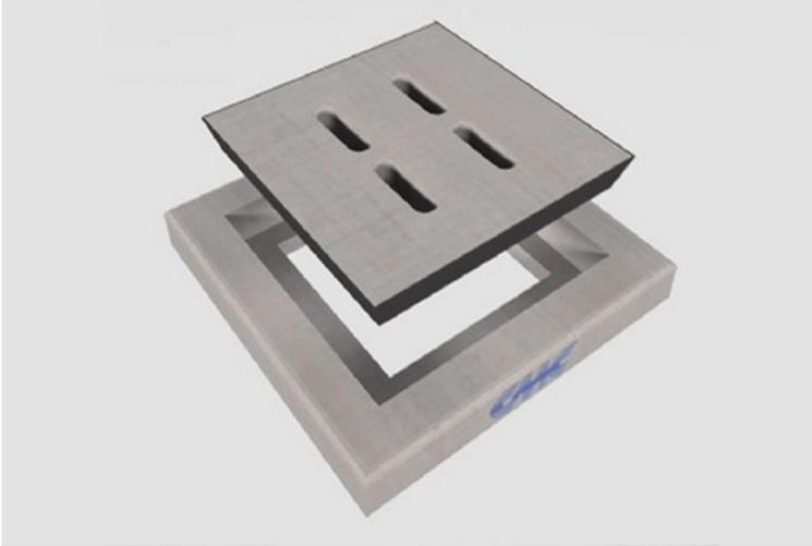
Elementi di chiusura per pozzetti e solette idonei ad aree pedonali non soggette al traffico veicolare, costituiti da telaio esterno con o senza anima interna in pvc e tappo interno dotato di feritoie per il passaggio dell'acqua piovana.
