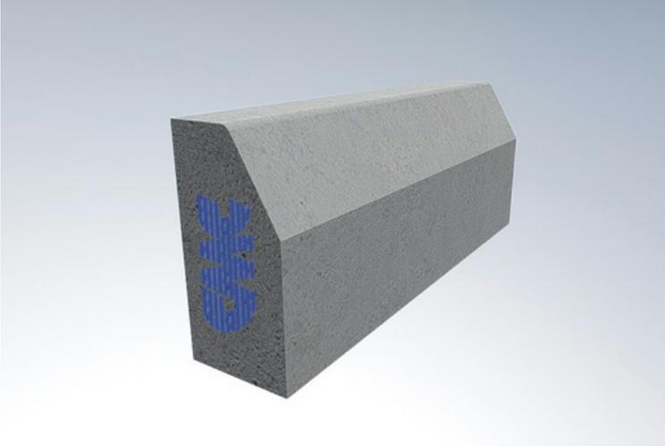
Cordoli realizzati in calcestruzzo vibro-compresso idonei per aree soggette al traffico veicolare in conformità alla norma UNI EN 1340, aventi sezione trapezoidale, muniti di smusso arrotondato sugli spigoli frontali e privi di incastro in testa.
