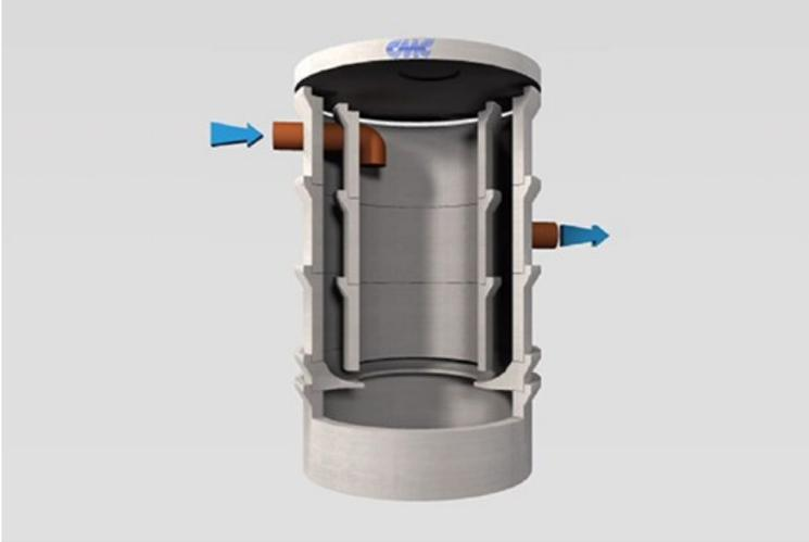
Degrassatori prefabbricati realizzati in calcestruzzo armato vibrato con finitura industriale, idonei alla separazione per gravità degli ammassi di materiale galleggiante prodotti dalla combinazione di oli, grassi e detersivi.
