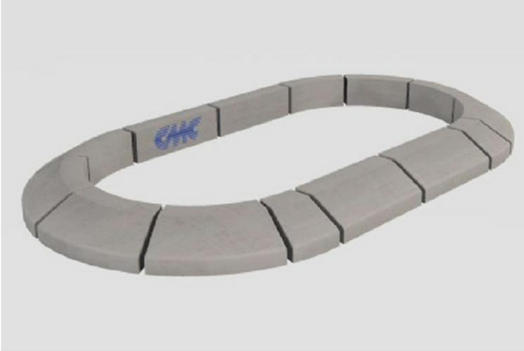
Cordoli spartitraffico prefabbricati senza ancoraggio posteriore realizzati in calcestruzzo vibrato (anche nella versione vibrocompresso solo nel cordolo retto da cm 50) , idonei per aree soggette al traffico veicolare in conformità alla UNI EN 1340 e impiegati generalmente per la realizzazione di rotatorie, isole spartitraffico e svincoli stradali.
