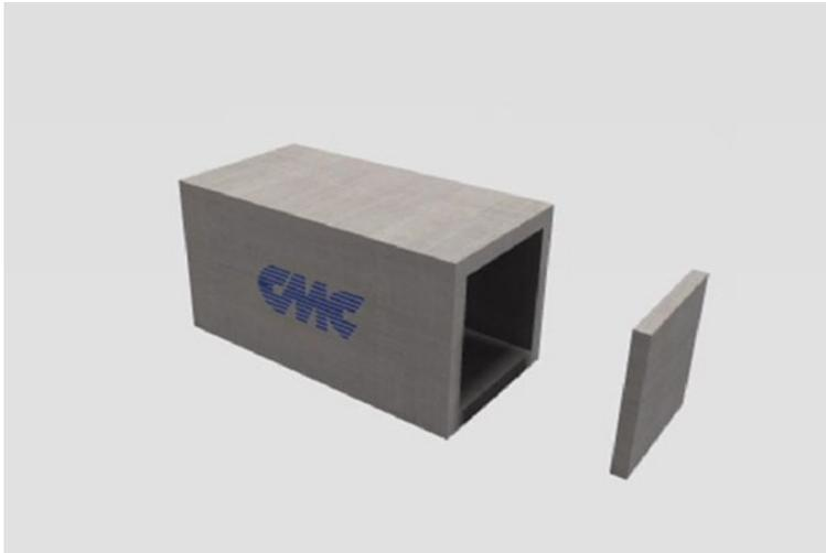
Cinerari modulari prefabbricati. Realizzati in calcestruzzo impermeabile ad alta resistenza armato e costipato senza l'ausilio di vibrazione meccanica, con finitura liscia priva di asperità e porosità.
