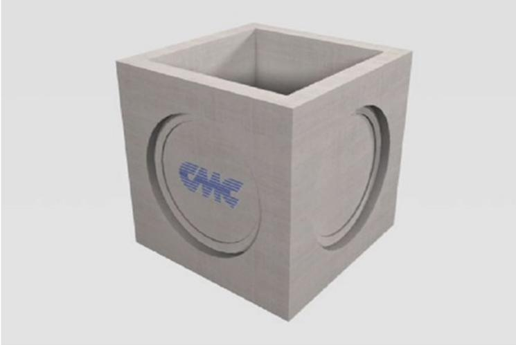
Pozzetti stradali con fondo o senza, in calcestruzzo armato vibrato, di sezione quadrata o rettangolare, muniti sulle pareti laterali di impronte a mezzo spessore di facile sfondamento in grado di ricevere tubi in calcestruzzo, pvc, pead o altro materiale.
