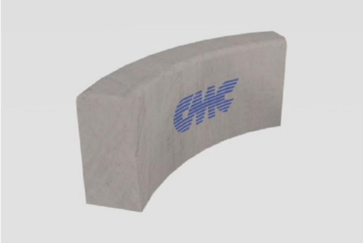
Cordoli curvi realizzati in calcestruzzo vibro-compresso idonei per aree soggette al traffico veicolare in conformità alla norma UNI EN 1340, aventi sezione trapezoidale, muniti di smusso arrotondato sugli spigoli frontali e privi di incastro in testa.
