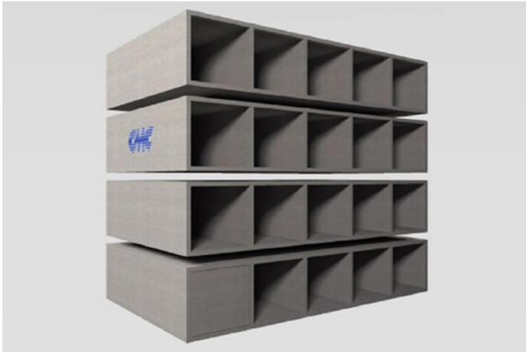
Loculi modulari prefabbricati. Realizzati in calcestruzzo SCC impermeabile ad alta resistenza armato e costipato senza l'ausilio di vibrazione meccanica, con finitura liscia priva di asperità e porosità.
