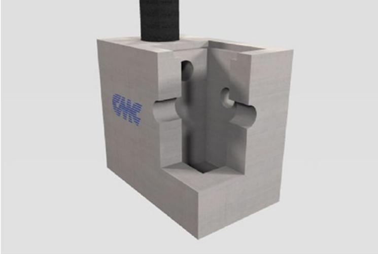
Plinti prefabbricati monolitici, realizzati in calcestruzzo armato vibrato con finitura industriale, muniti di pozzetto di ispezione incorporato, di foro superiore per l'alloggiamento di un palo per illuminazione, di fori passanti per il passaggio di cavi e di un foro centrale sul fondo del pozzetto per la messa a terra.
