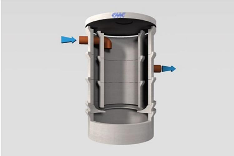
Disoleatori/dissabbiatori prefabbricati ideati per la separazione di liquidi leggeri per gravità e per la sedimentazione e raccolta di sabbie ed altri materiali pesanti, realizzati in calcestruzzo armato vibrato con finitura industriale.
