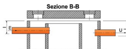
Sezione coperchio per fosse DN 1000
