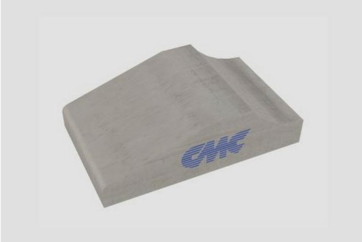
Cordoli spartitraffico denominati anche "tipo provincia" sono realizzati in calcestruzzo vibrato, dotati di ancoraggio posteriore con fori passanti per il fissaggio attraverso tirafondi in acciaio. Idonei per aree soggette al traffico veicolare in conformità alla UNI EN 1340, sono impiegati generalmente per la realizzazione di rotonde, isole spartitraffico e svincoli stradali.
